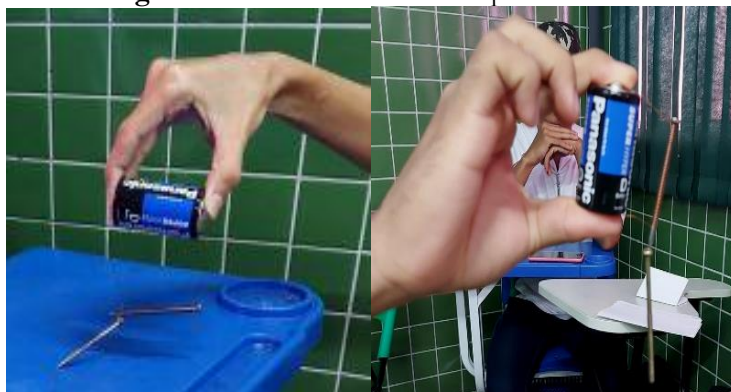
Figura 05: Eletroímã construído pelos alunos.
